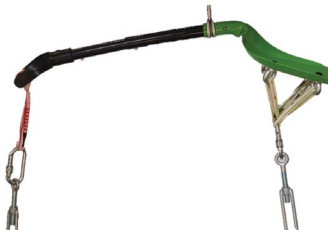
Replica in laboratorio di un modo di collasso (flessione su tre punti)
